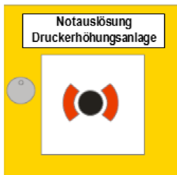
Abb.2: Handsteuereinrichtung zur Notauslösung der DEA
